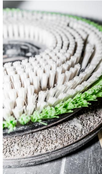
**1** Jeder Belagsverlegung voraus geht eine Untergrundprüfung und eine darauf abgestimmte Untergrundvorbereitung. Bei Arbeiten im Bestand können auch festliegende alte Fliesen die Grundlage der Neuverlegung bilden. Hierzu müssen diese grundgereinigt werden.
